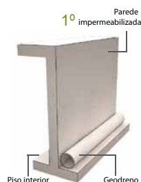
● Representação 2D da construção de cortina drenante em parede enterrada
