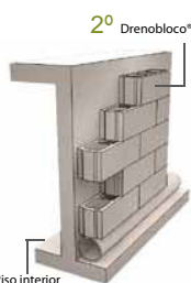
● Representação 2D da construção de cortina drenante em parede enterrada
